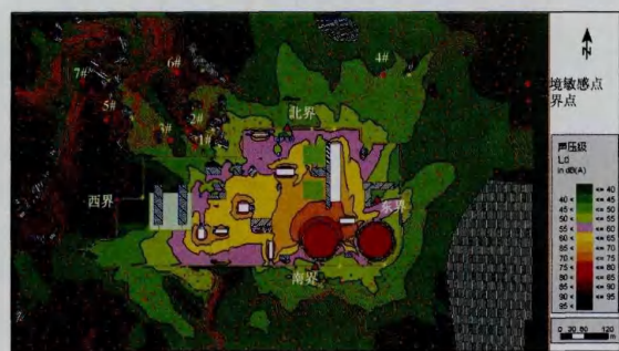
图3 设通风消声装置后电厂噪声贡献值的等声级线图
